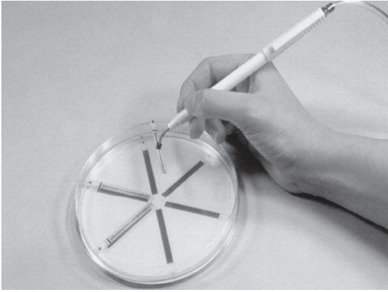
Şekil 2. G-test şeritlerinin yerleştirilmesi.
